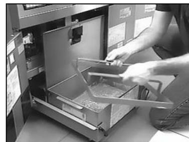
2. Retirez le papier filtre, le cas échéant, et nettoyez le bac si nécessaire. Après avoir vérifié que le filtre métallique se trouve au fond du bac, posez une feuille de papier filtre propre sur le dessus du bac, en la faisant déborder sur tous les côtés.
